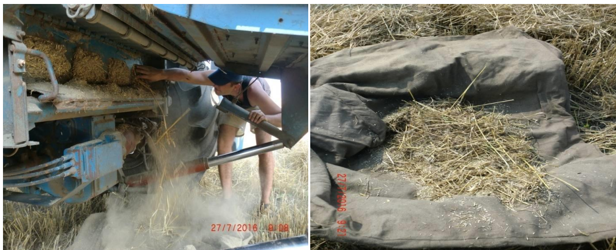
Рис. 4.2 – Відбирання маси із каменеуловлювача зернозбирального комбайна ( a ) та вигляд цієї маси ( б )
