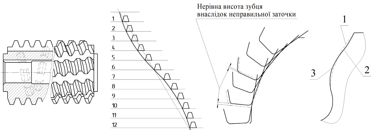
Рис. 1.6 Вплив відхилення вісєвого кроку фрези на оброблюваний профіль
