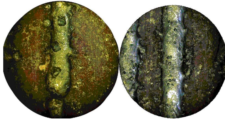
Рис. 3.1. Характерні валики алмазвміщуючого композиту, одержані лазерним спіканням (за [88])
