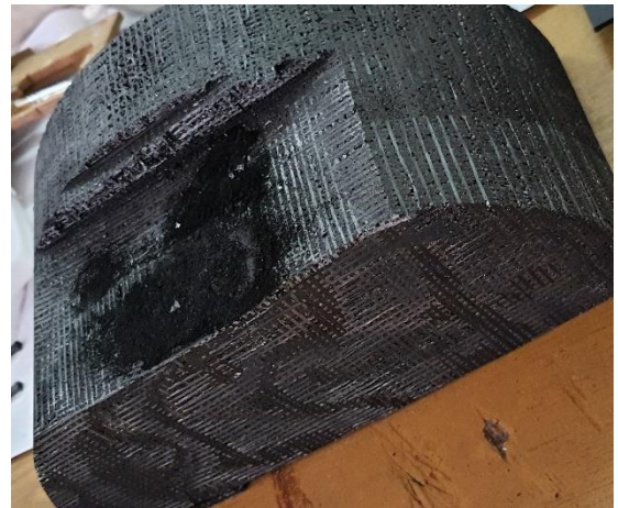
Рис. 4.13. Порівняння об'ємного зйому матеріалу КІМФ звичайним інструментом із малою часткою алмазних зерен (1), трубокругом (2), сегментним (3) та інструментом пропонованої конструкції (4)
