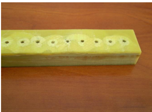
Рис.1.5. Фото торців виробів із вуглецевих композитів при свердлуванні (а) гідрострумина обробки склотекстоліту (б), в якому виконано також кілька отворів з неповним прорізанням
