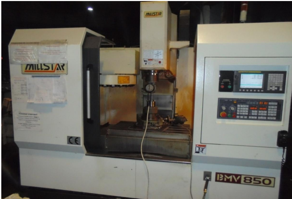
Рис. 4.1 Обробний центр з ЧПК моделі BMV-850 MILLSTAR, оснащений пристроєм для профільного шліфування внутрішніх поверхонь і пристроєм для відтворення руху обкату
