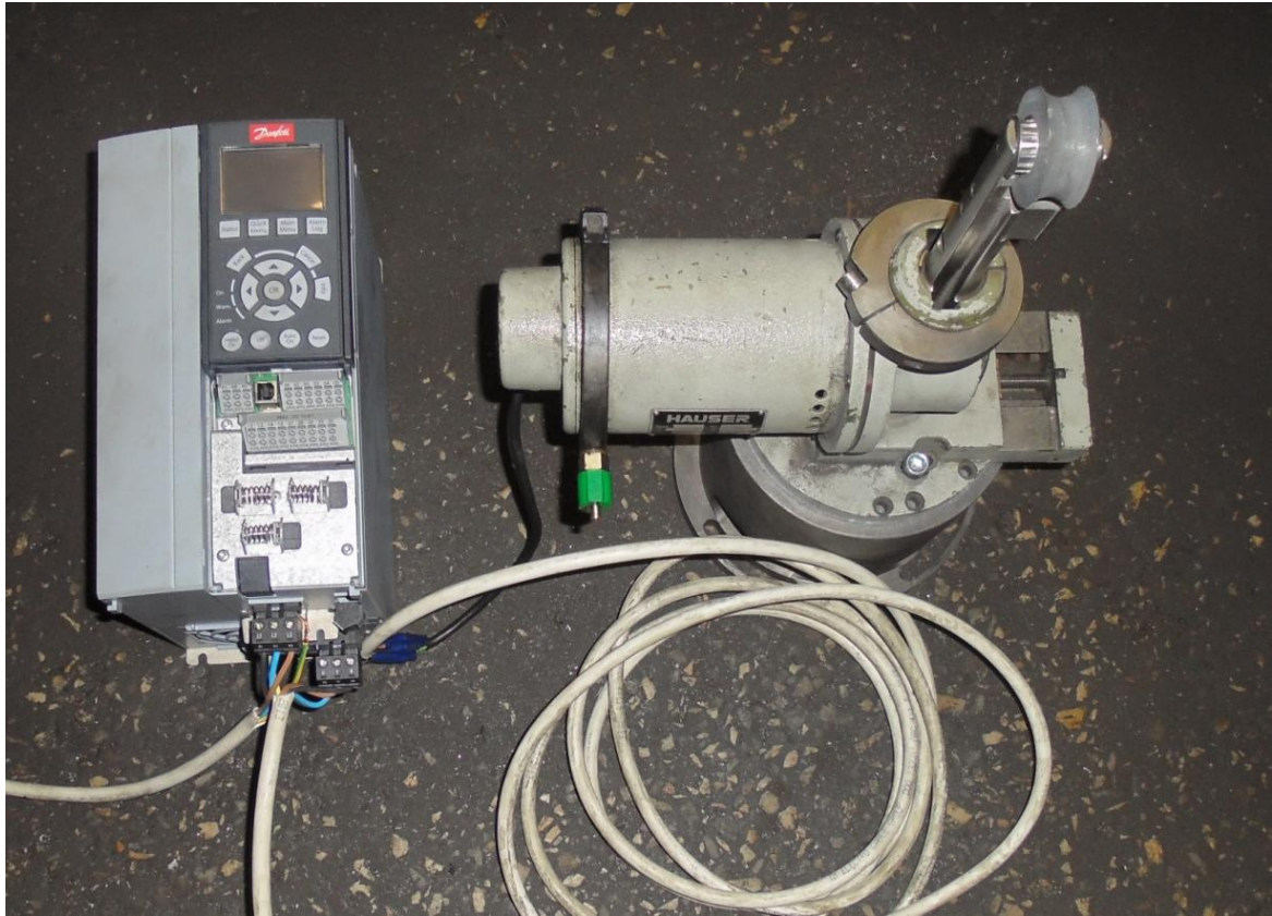
Рис. 4.3 Пристрій для профільного шліфування внутрішніх поверхонь Hauser і частотний перетворювач Danfoss VLT AQUA Drive FC202
