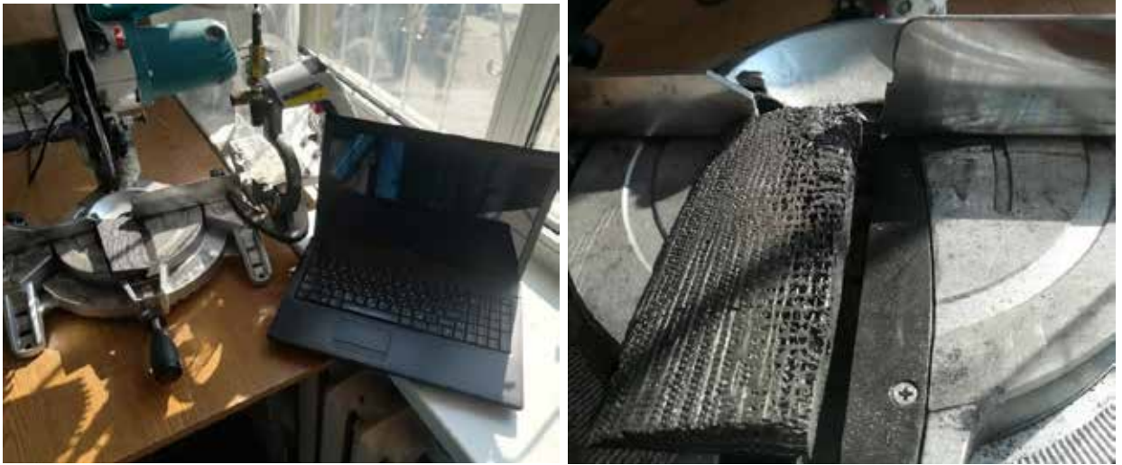
Рис. 2.3. Пірометричний комплекс для визначення температури в зоні різання при обробці нещільних матеріалів: а) загальний вигляд; б) досліджуваний зразок
