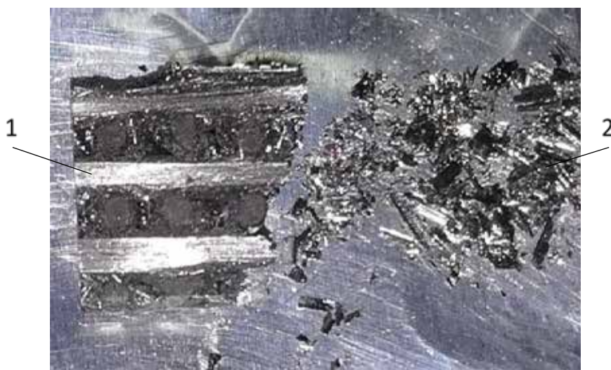
1 – фрагмент матеріалу; 2 – шлам після обробки
