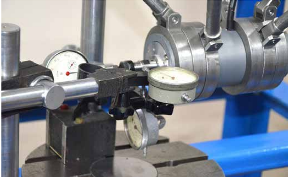
Рис. 2.14. Вимірювання пружних деформацій просторової несучої системи верстата
