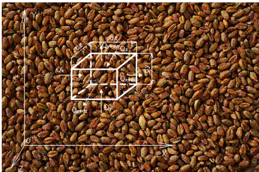
Рис. 2.1. Схема для моделювання теплового потоку в зерновому середовищі
