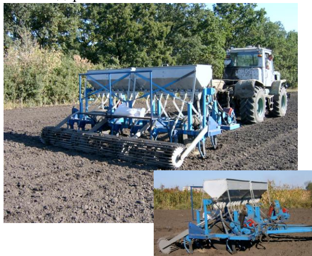
Рис. 1. Загальний вигляд агрегата для безвідвального обробітку ґрунту з одночасним внесенням мінеральних добрив.
