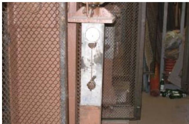
Рисунок 2. - Загальний вигляд призми в установці для тривалих випробувань
