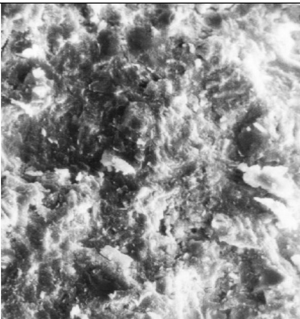
Рисунок 5 - Мікроструктура цементного каменю (збільш. в 3000 раз), гідратованого 28 діб, з В/Ц=0,3 (а) та 0,5 (б)
