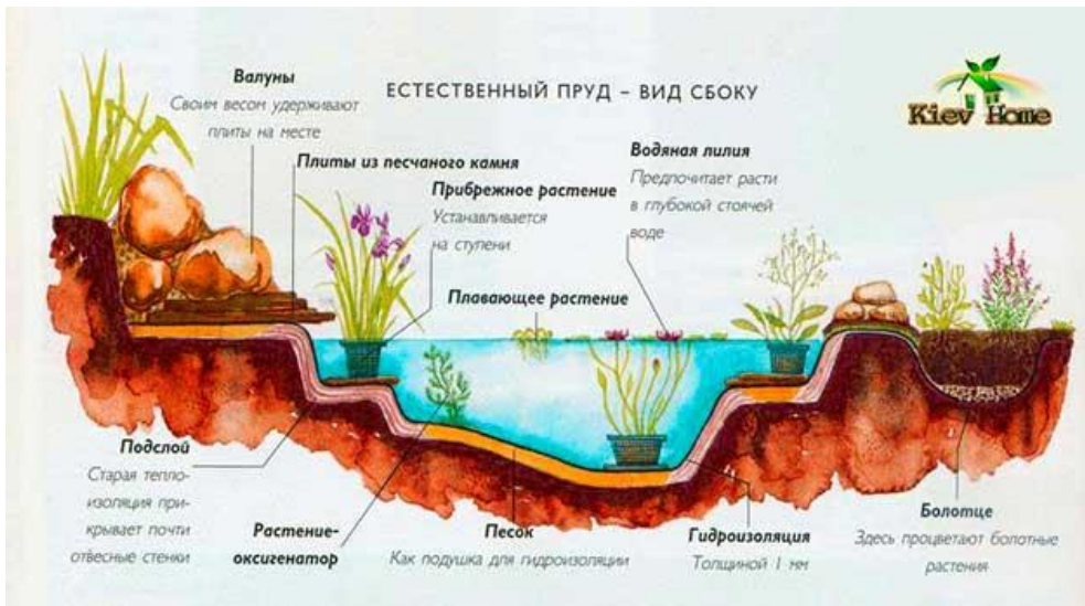
Рисунок 3 – Схематичний розріз декоративної водойми.
