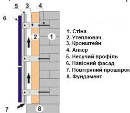
Рисунок 1 – Конструкція фасаду з вентиляльованим прошарком
