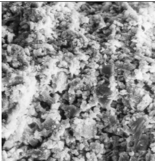
Рисунок 5 - Мікроструктура цементного каменю (збільш. в 3000 раз), гідратованого 28 діб, з В/Ц=0,3 (а) та 0,5 (б)
