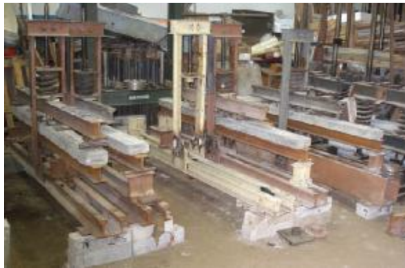
Рисунок 1. - Загальний вигляд балок на тривале випробування
