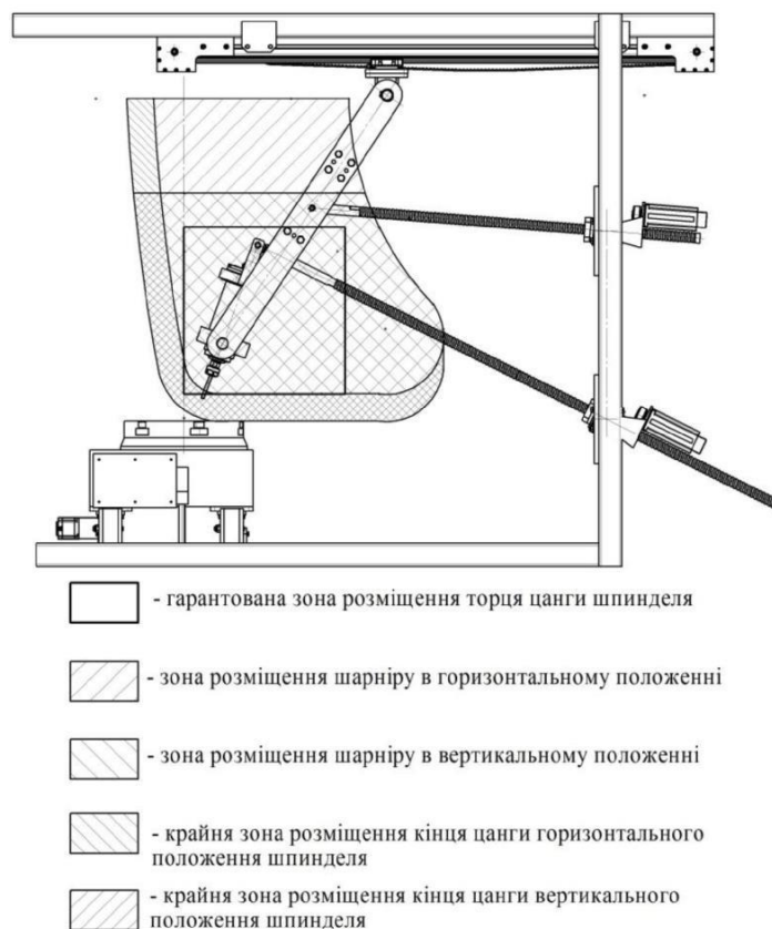
Рисунок 5 – Робоча зона гібридного верстата
