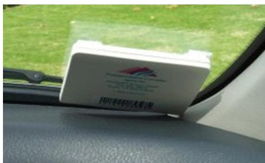
Рисунок 3 – місце кріплення RFID Мітки на транспортному засобі
