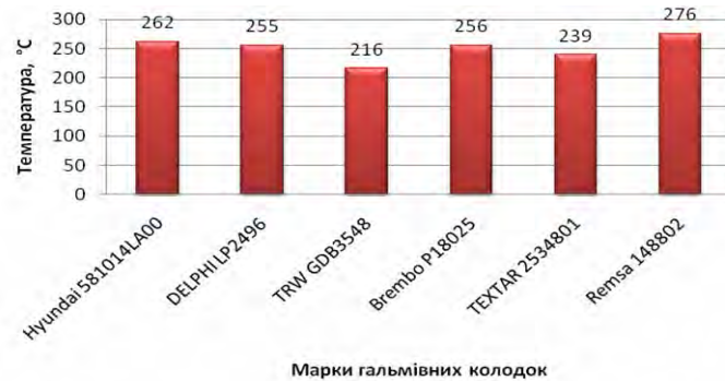
Рисунок 3 – Величини температурного режиму колодок при гальмуванні в умовах «гірського серпантину»
