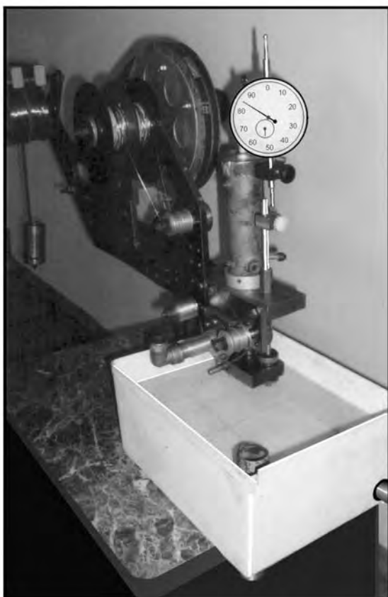
Рисунок 8 – Експериментальний верстат моделі «Ніж-1» для електродугового різання металів дровими електродами-інструментами Джерело: розроблено авторами
