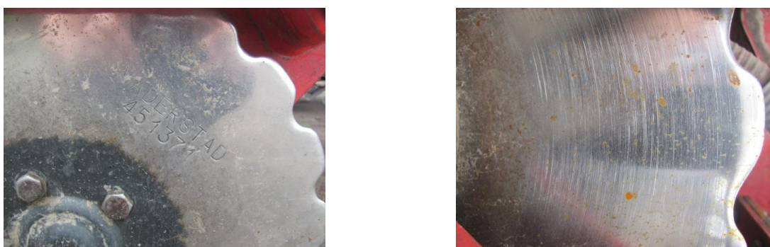
Рис. 1. Характерный вид поверхности трения рабочего органа посевного комплекса VADERSTAD Rapid A 800 C:
