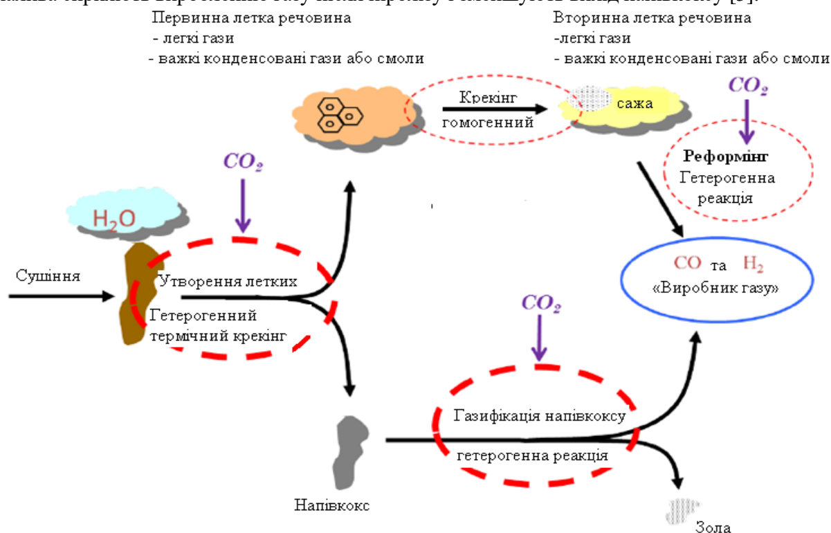
Рис. 1. Етапи і реакції, що виникають в процесі газифікації твердого біопалива і потенційний вплив на нього \text{CO}_2
