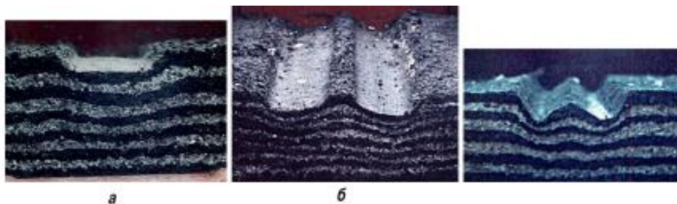
Рис. 1. Картини розподілення полів деформацій під прикочуючими котками різних конструкцій при щільності ґрунту 0,8 \text{ г/см}^3 та вологості 21 – 23%: а – еліптичного; б – V – подібного; в – конічного профілю
