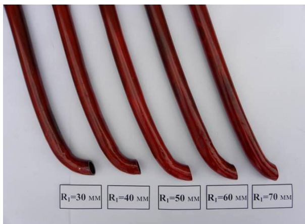
Рис. 2. Загальний вигляд туконапрячників із різними радіусами кривизни
