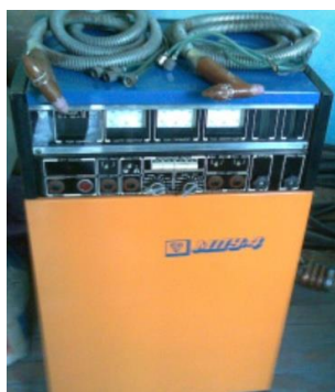
Рис. 1. Зовнішній вигляд (а) та структурна схема (б) установки мікроплазмового зварювання типу МПУ-4
