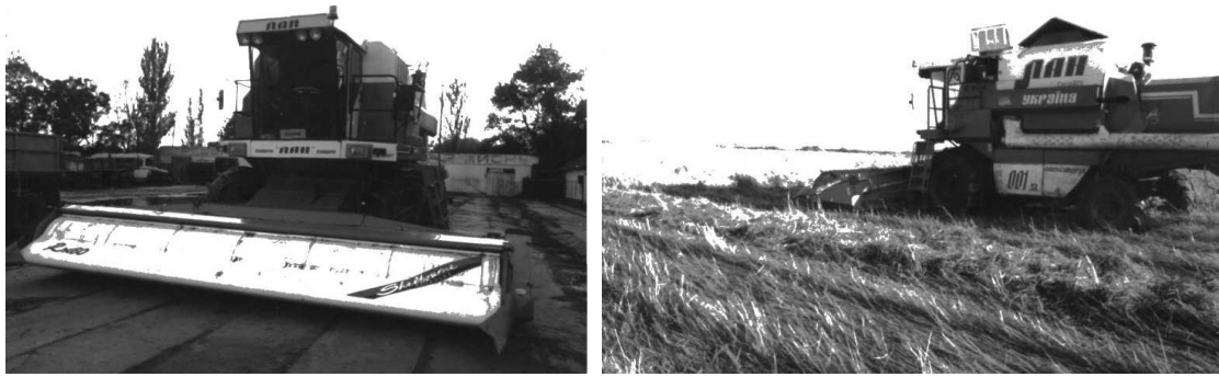
Рис. 1 Загальний вигляд комбайна «Лан», обладнаного обчісуючою жниваркою фірми "Шельборн Рейнольдс" на збиранні рису
