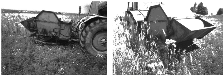
Рис. 3 Польові випробування макетного зразка двохбарабанної обчісуючої жатки
