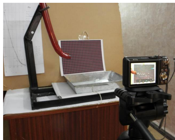
Рис. 3. Визначення швидкості частин мінеральних добрив з використанням методу визначення координат
