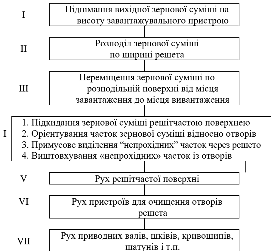
Рис. 2. Операції і стадії процесу сепарації зерна на традиційних зерноочисних машинах
