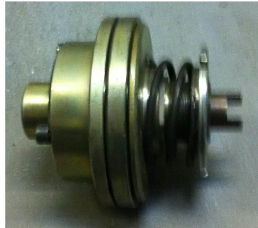
Рис. 2. Загальний вигляд пружно-запобіжної муфти з плавним пуском
