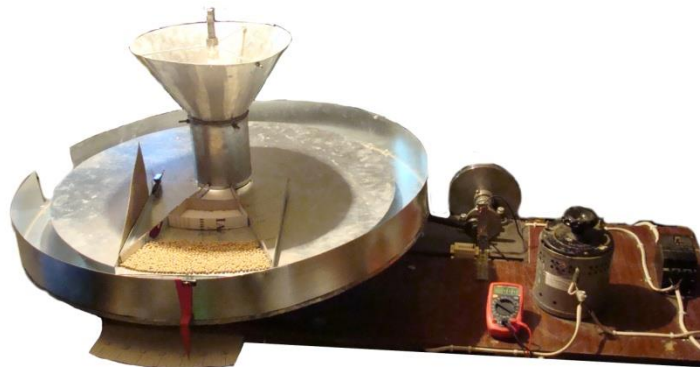
Рис. 1. Експериментальний зразок мікронізатора зернових матеріалів з похилою круговою вібраційною поверхнею
