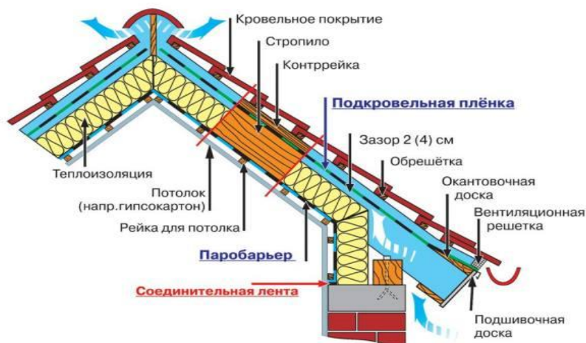
Рисунок 1 – конструкція мансардного даху
