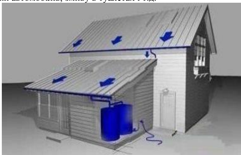
Рисунок 3 – Система для збору дощової води
