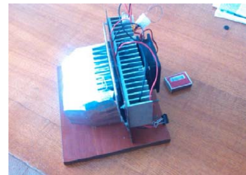
Експериментальна установка ТГМ за принципом Зеебека на основі ТЕМ TEC1-12706-40
