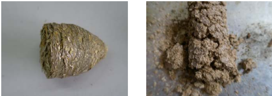
а) – брикет із сировини із низькою вологістю (пелет не утворився), б) – пелетіз сировини з надмірною вологістю
