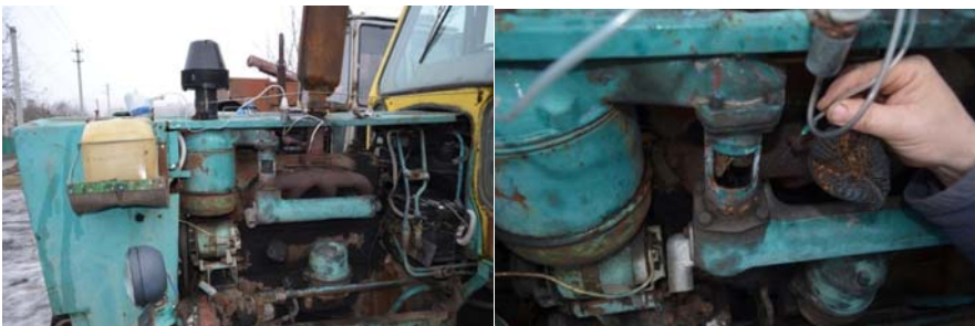
Рисунок 1-2 – Система використання воднопаливної суміші в дизельному двигуні трактора ЮМЗ-6
