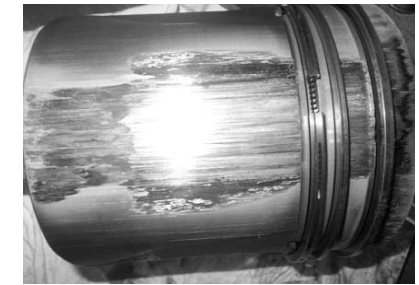
Рисунок 6 – Задир поршня двигателя Jenbacher 420
