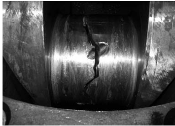
Рисунок 1 – Вид шатунной шейки коленчатого вала двигателя ГЧН25/34 после поломки
