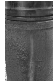
Рисунок 5 – Вертикальная трещина на гильзе рабочего цилиндра двигателя 6ГЧН25/34
