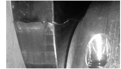
Рисунок 4 – Вид щеки коленчатого вала двигателя Jenbacher 420 после поломки
