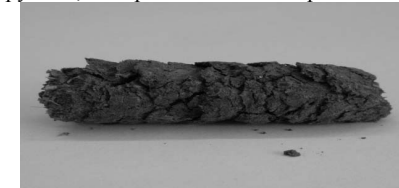
Рисунок 2 – Вигляд пелет, виготовлених з тирси вологістю 30% при застосуванні матриці з короткою циліндричною частиною
