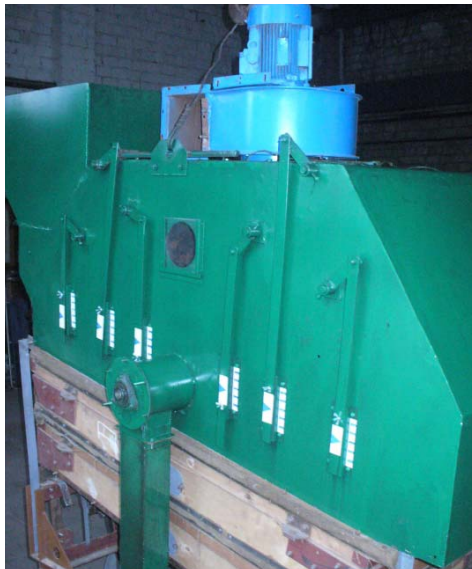
Рисунок – 1. Загальний вид модернізованої аспіраційної камери плоскорешітного сепаратора Ефективність осадження легких домішок E_k , рахували за формулою:
