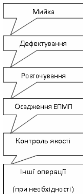
Рисунок – 1. Схема технологічного процесу відновлення зношених внутрішніх поверхонь бронзових втулок ЕПМП на основі міді
