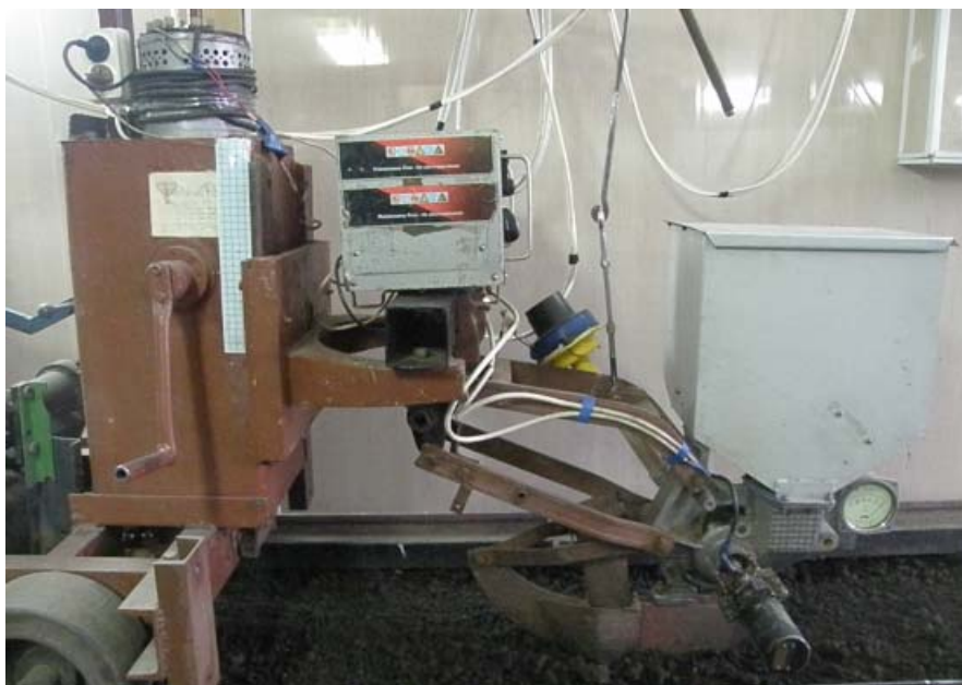
Рисунок – 2. Загальний вигляд дослідного зразка секції у ґрунтовому каналі
