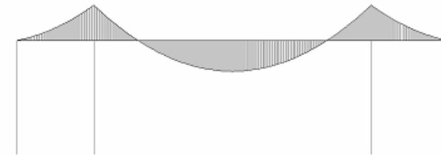
Рисунок 3 – Епюра вигинаючих моментів балочної рами
