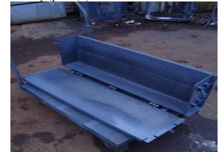
Рисунок 3 – Пристрій (віброформа) для виготовлення одного залізобетонного бордюру
