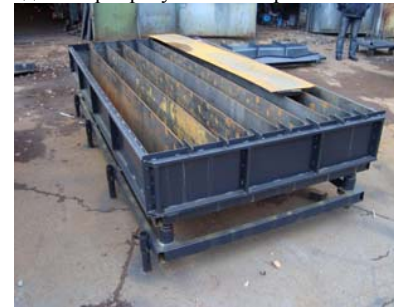
Рисунок 2 – Пристрій (віброформа) для одночасного виготовлення восьми залізобетонних бордюрів
