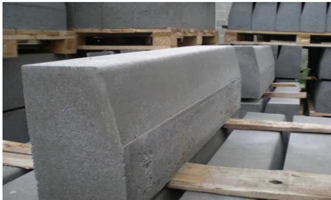
Рисунок 5 – Загальний вигляд сучасного дорожнього залізобетонного бордюру традиційної конструкції за умови зберігання або транспортування його на піддонах
