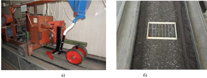
а) – загальний вигляд експериментальної установки в ґрунтовому каналі; б) – рамка зі струнами
