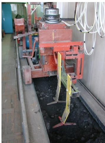
Рисунок 2 – Дослідження робочих органів розпушувача на ґрунтовому каналі
