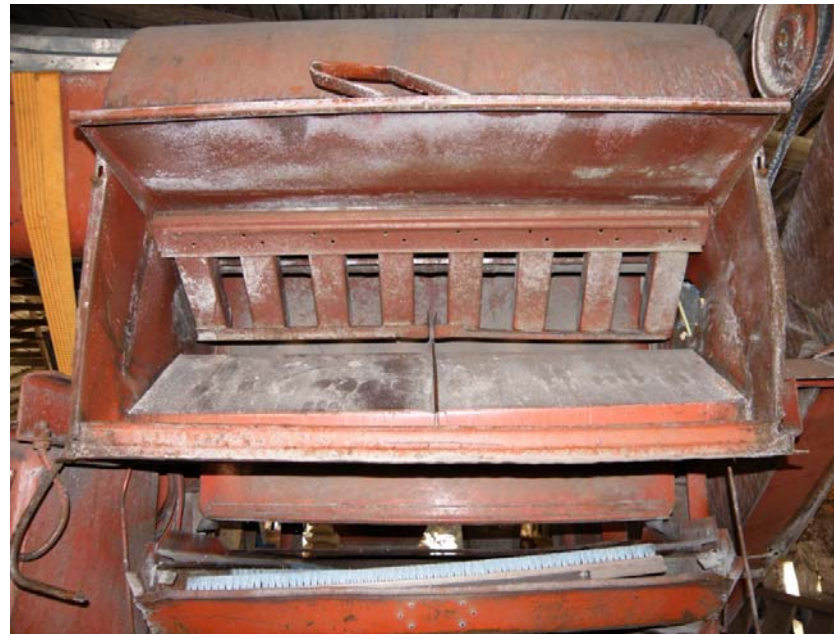
Рисунок 2 – Загальний вигляд однорівневого механізму введення вороху до аспірації зерноочисної машини ОВС-25
