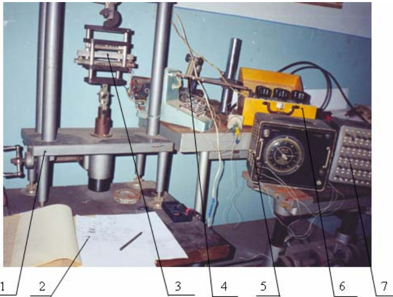
1–універсальний прес УПІ–8; 2–протокол реєстрації показів; 3–еталонна балочка; 4–навантажена балка із компенсаційними тензорезисторами; 5–вимірювач деформацій з автоматичним балансуванням моста АІІ–1; 6–магазин опорів; 7–комутаційний блок
