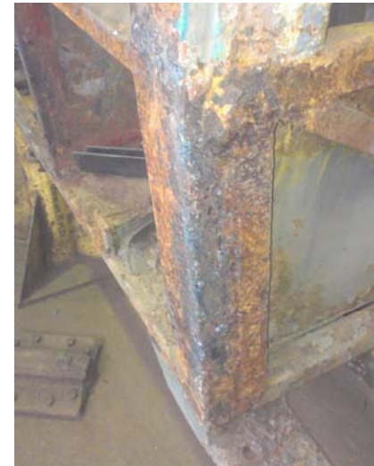
Рисунок 2 – Спрацьована рама тролейбуса після заняття листової оболонки
