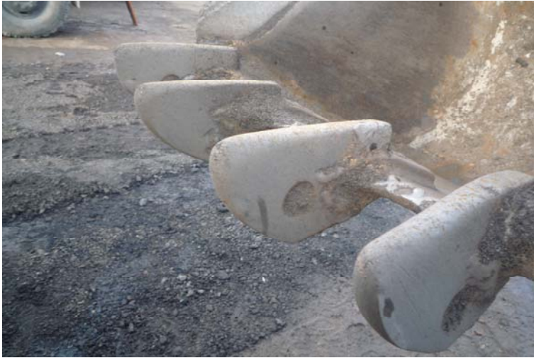
Рисунок 1 – Локальне зношування ріжучих крайок робочого органу однокішшового екскаватора ЭО-2621. (Виробничий експеримент з використанням машинного парку Кіровоградська ДЕД ДП Кіровоградський облавтодор)
