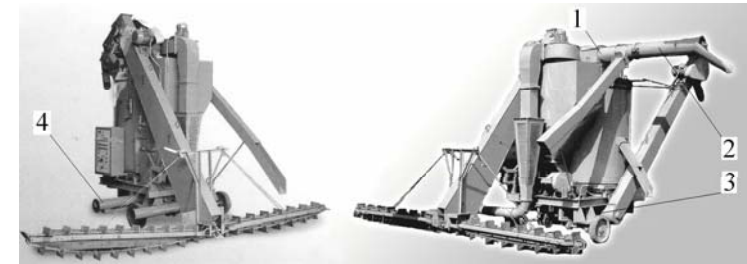
1 – шнековий живильник; 2 – відкидний шнек; 3 – шнек чистого зерна; 4 – шнек для видалення відходів (домішок)
