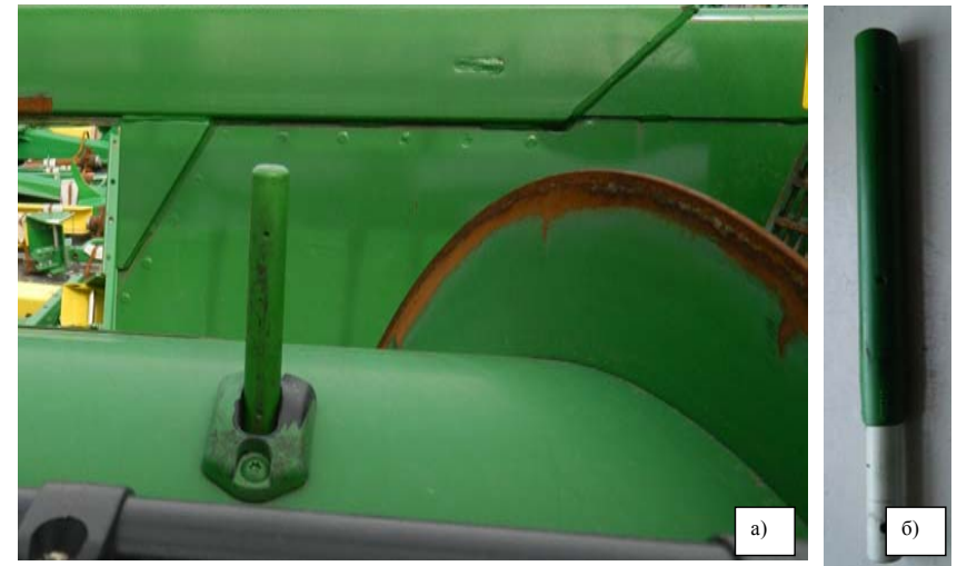
Рисунок 1 – Палець шнека жатки John Deere в робочому положенні (а) і його загальний вигляд (б)
