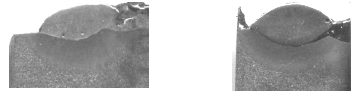
а – проволокой Нп-30ХГСА; б – проволокой Нп-30ХГСА с добавкой порошка ПГ-10Н-01
