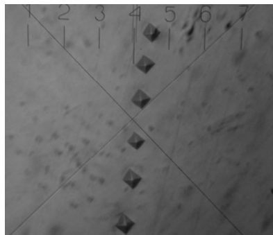
Рисунок 4 – Вимірювання отпечатків мікротвердості на приладі ПМТ-3 (×500)
