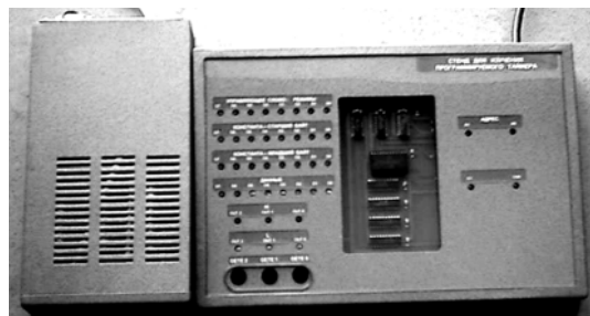
Рисунок 2 – Апаратний емулятор (стенд) мікросхеми і8253
