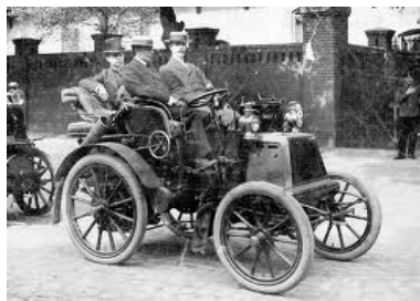
Рисунок 3 – Автомобіль Даймлера-Майбаха з чотирициліндровим двигуном
