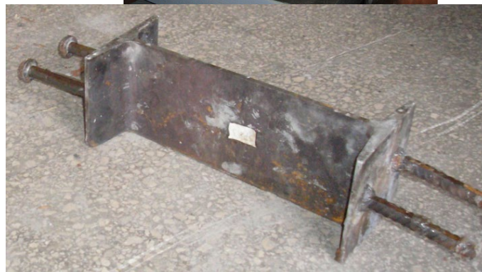
Рисунок 1 - Експериментальні дослідження коротких зразків на зріз (виконані Дарієнко В.В. [3])
