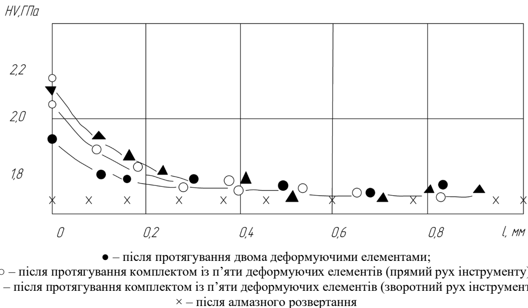
Рисунок 5 – Розподіл твердості по товщині стінки корпусу при деформуючому протягуванні отвору
