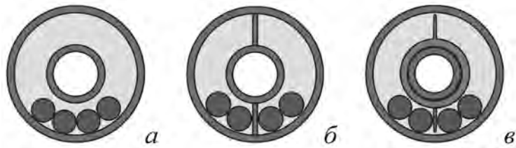
а – звичайний; б – з нерухомими (патент № 75189); в – з рухомими перегородками (патент № 26788). Рисунок 2. Кульові АБ
