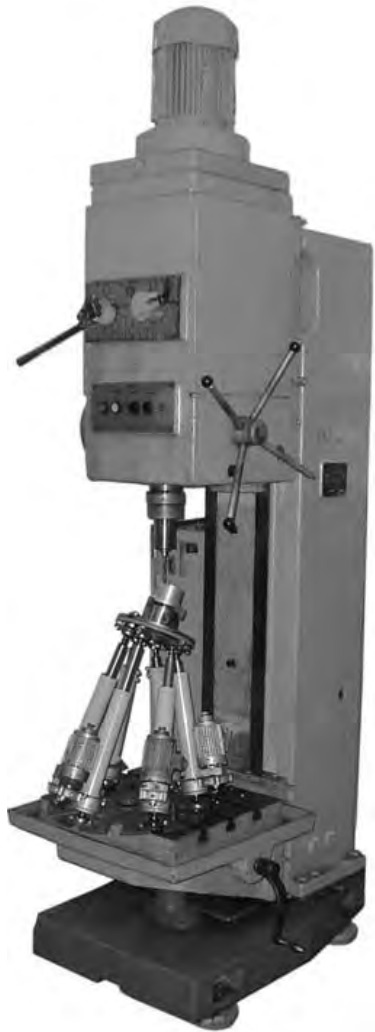
Фото 3. Свердильний верстат, оснащений столом-гексаподом
