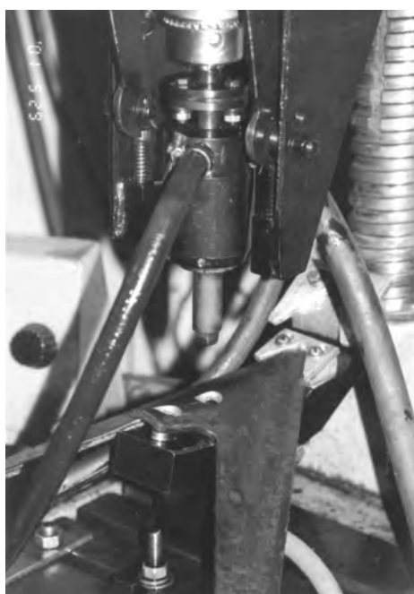
Обробка отворів із фаскою в лапах культиватора на свердлувальному верстаті із ЕЕГ “АМН-1”
