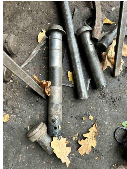
Рис. 1. Триботехнічне спряження стріли екскаватора (а) та елемент трибоспряження (б)
