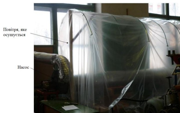
Рис. 2. Експериментальна установка для осушення повітря у тваринницьких приміщеннях.
