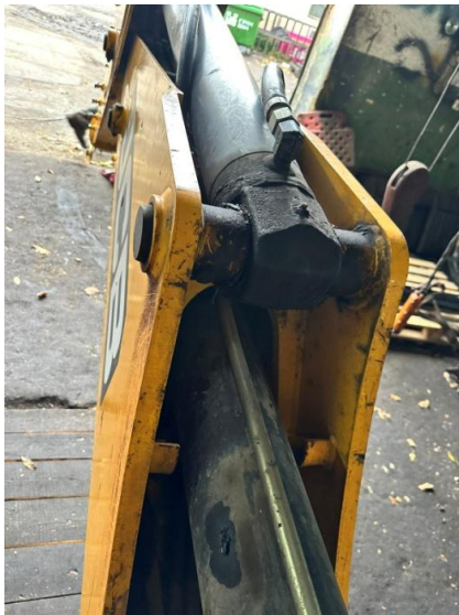
Рис. 1. Триботехнічне спряження стріли екскаватора (а) та елемент трибоспряження (б)
