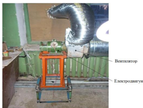
Рис. 4. Підключення електродвигуна до відцентрового вентилятора
