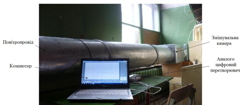
Рис. 3. Експериментальна установка для осушення повітря у тваринницьких приміщеннях
