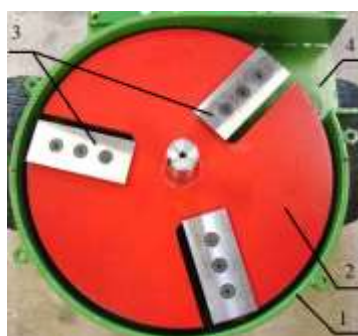
Рис. 2. Дисковий подрібнювач листостеблової маси з горизонтальною віссю обертання (передню стінку з протирізальною пластиною не показано):
