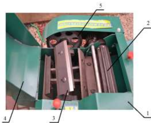
Рис. 4. Роторний (барабанний) подрібнювач листостеблової маси з горизонтальною віссю обертання:
