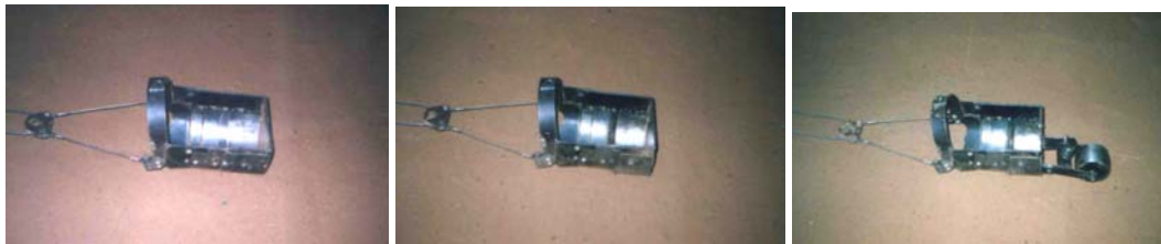
Рисунок 1 – Фізичні масштабні моделі ковша екскаватора-драглайна
