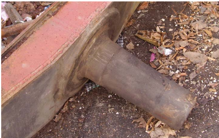
Рисунок 2 – Вирізана балка трамваю з пошкодженим шкворнем
