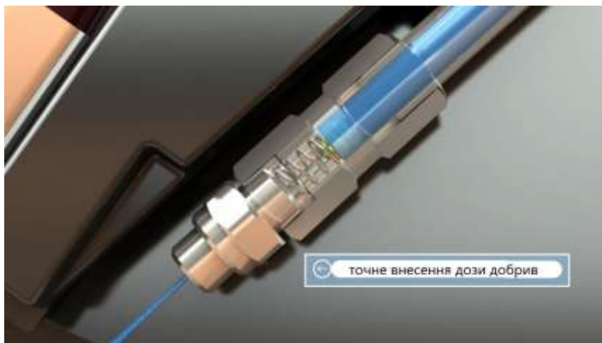
Рис. 3. Запірний клапан системи дозування
