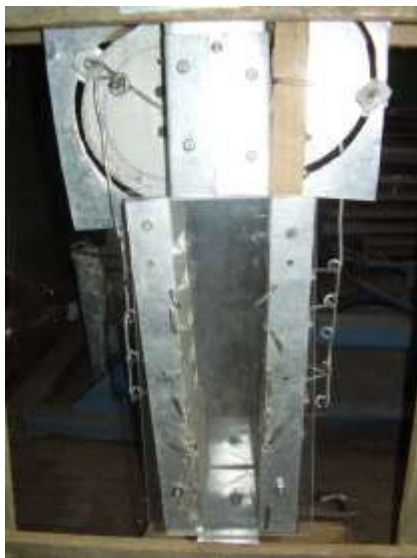
Рис. 2. Жалюзійна камера дослідного пневматичного сепаратора
