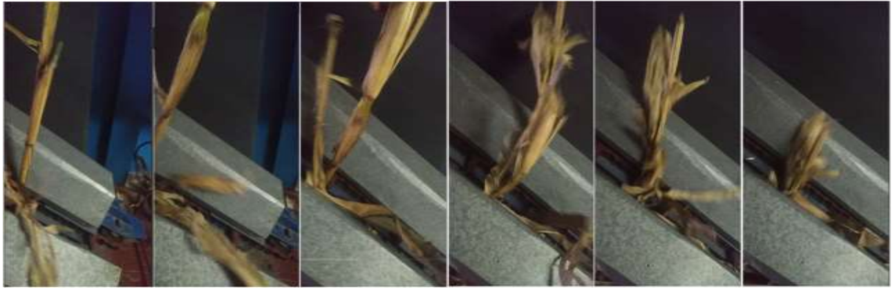
Рис. 2. Процес протягування стебла відривним апаратом лабораторної установки
