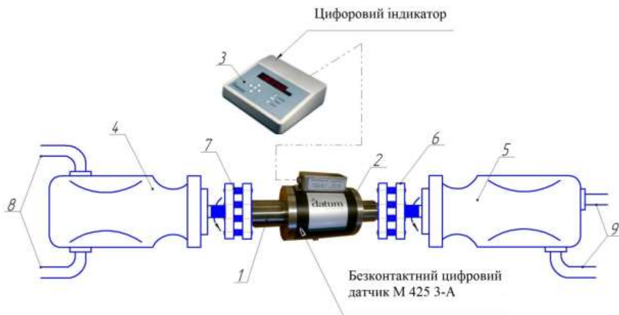
Рис. 2. Схема вимірювання крутного (гальмівного) моменту, що розвивається випробувальним гідромотором за допомогою безконтактного цифрового датчика М 425 3-А date electronics:
