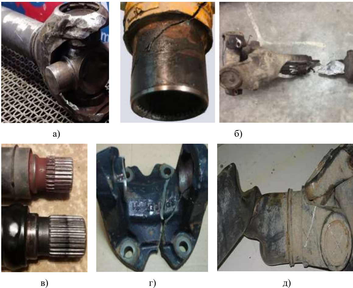
Рис. 1. Руйнування елементів карданних передач: а) – вилок шарнірних механізмів; б) – шліцьових з'єднань; в) – знос шліців; г) – фланців; д) – скручування валів
