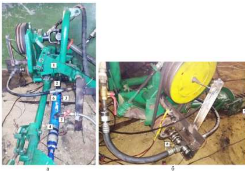
Рис. 2. Вид з боку ножа (а) та з боку приводних шківів (б) модернізованої конструкції приводу сегментно-пальцевої косарки КС-2,1:
