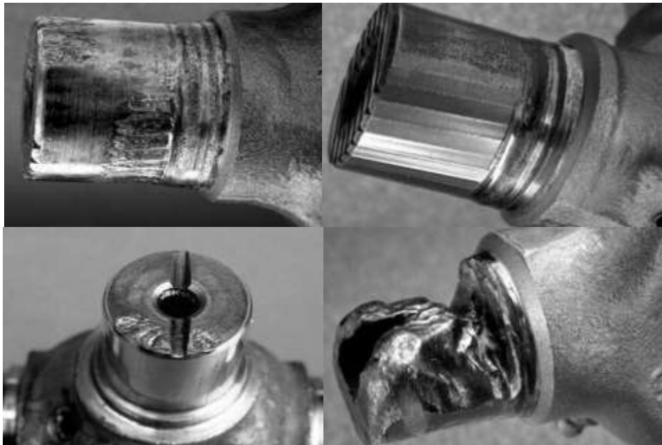
Рис. 2. Знос і руйнування робочих поверхонь хрестовини карданного вала
