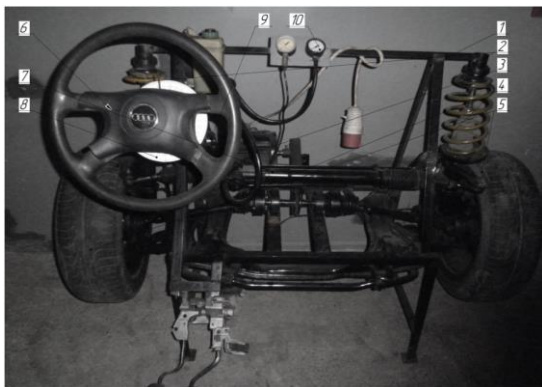
Рисунок 2 - Стенд для дослідження параметрів кермових та гальмівних властивостей автомобіля
