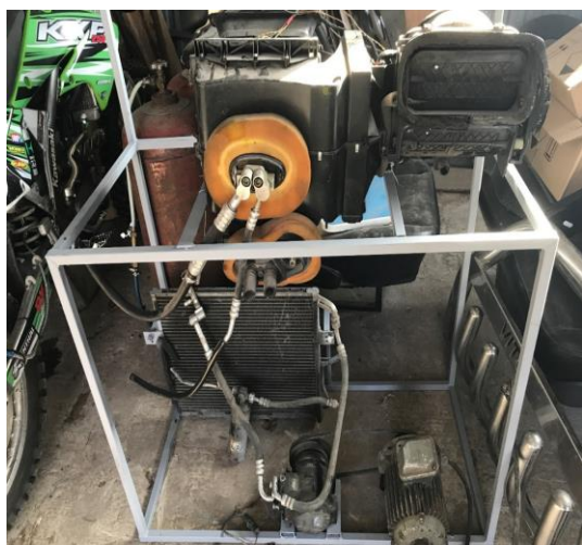
Рисунок 1 - Навчальний лабораторний стенд 1-агрегат системи кондиціонування; 2-рама; 3-інформаційний плакат; 4-блок керування кліматичною установкою; 5-радіатор кондиціонера; 6-радіатор; 7-компресор; 8-електродвигун; 9-блок живлення установки 12V; 10-вимикач.
