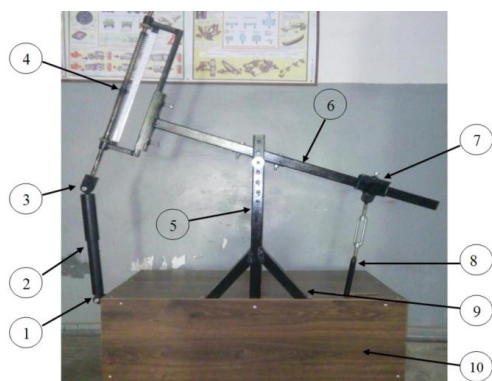
Рисунок 1 - Стенд для перевірки та визначення робочих параметрів амортизаторів: 1 – нижнє кріплення амортизатора; 2 – амортизатор; 3 – верхнє кріплення амортизатора; 4 – динамометричний механізм; 5 – стійки; 6 – коромисло; 7 – повзун; 8 – шатун; 9 – корпус; 10 – захисна обшивка.
