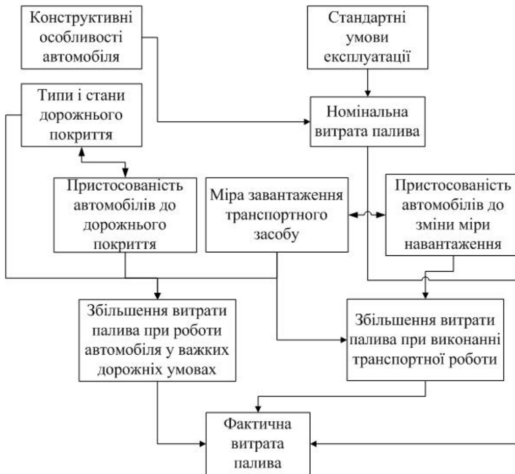
Рисунок 1 Схема механізму формування витрати палива автомобілів з різним завантаженням в залежності від типу і стану дорожнього покриття
