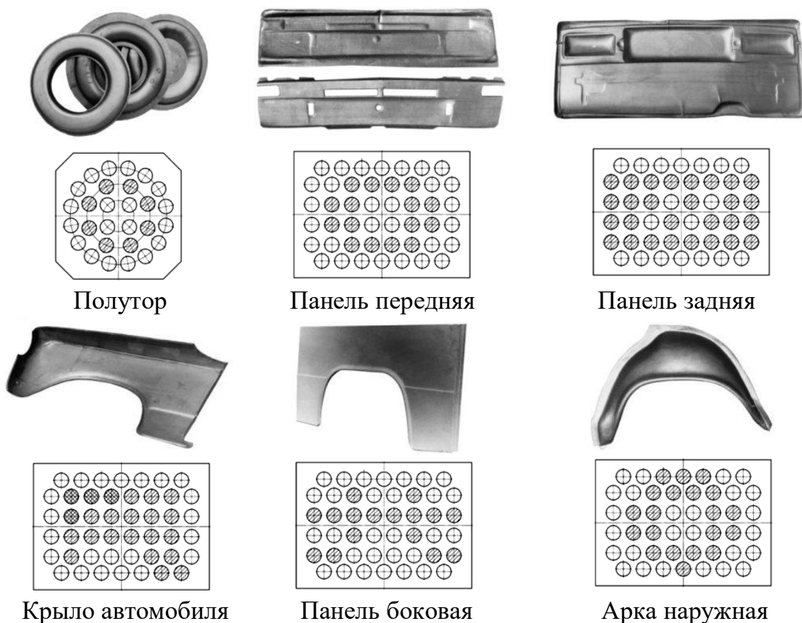
Рисунок 4 – Варианты используемой структуры поля нагружения для различных деталей. Заштрихованные круги – разрядные полости, в которых производится разряд одного контура (одиночная штриховка) и двух контуров (двойная штриховка, см. Крыло автомобиля)
