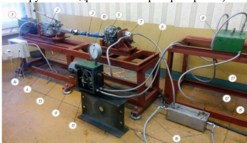
Рисунок 1 – Стенд для випробування карданних передач: 1 – електродвигун; 2 – коробка передач; 3 – карданна передача; 4 – основна рама; 5 – роздавальний редуктор; 6 – поздовжня рама; 7 – гідронасос; 8 – бак; 9 – дросель; 10, 13 – манометри; 11 – запобіжний клапан; 12 – охолоджувач; 14 – щит управління; 15, 16 – підведення електроенергії, води; 17 – гідравлічні шланги
