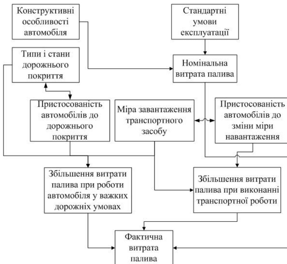
Рисунок 1 – Механізм формування витрати палива автомобілів з різним завантаженням в залежності від типу і стану дорожнього покриття
