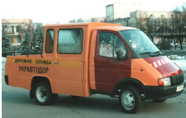
Рисунок 2 – Варианты моделей автобусов с одинаковыми кузовными панелями: а – микроавтобус специального назначения; б – машина дорожной службы
