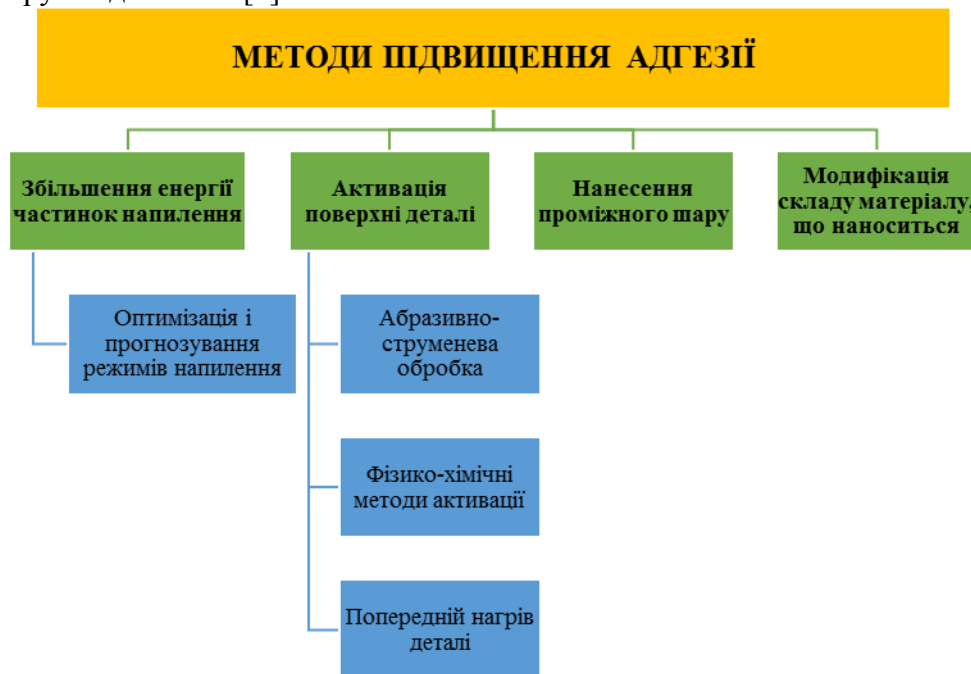
Рисунок - Методи підвищення міцності зчеплення
