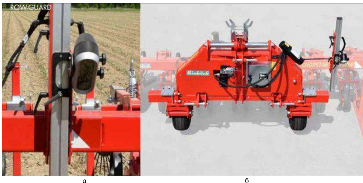
Рисунок 2 – Основні елементи Camera steering system ROW-GUARD [15, 16] : а – відеокамера з двома об'єктивами високої чіткості з різною експозицією для поліпшення роботи при зміні умов світла; б - система зміщення культиватора відносно рядка рослин
