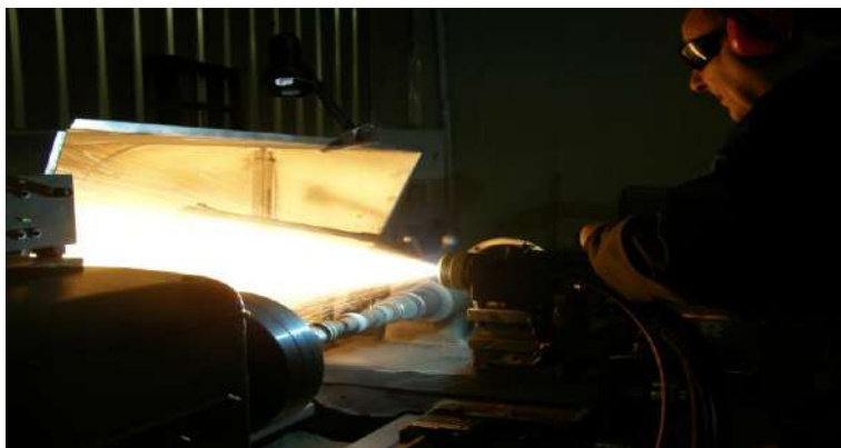
Рисунок 2 – Процесс нанесения покрытий на распредвал методом ЭДН
