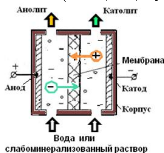
Рисунок - Схема электрохимического реактора для электроактивации раствора
