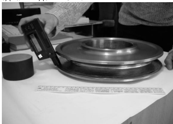
Рисунок 3 – Процес вимірювання твердості поверхні профілю канатного блоку після обкатування
