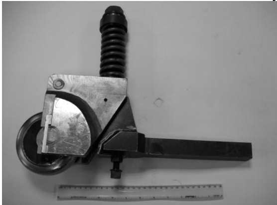
Рисунок 1 – Зовнішній вигляд експериментального пристрою для обкатування канатних блоків клиновим роликом
