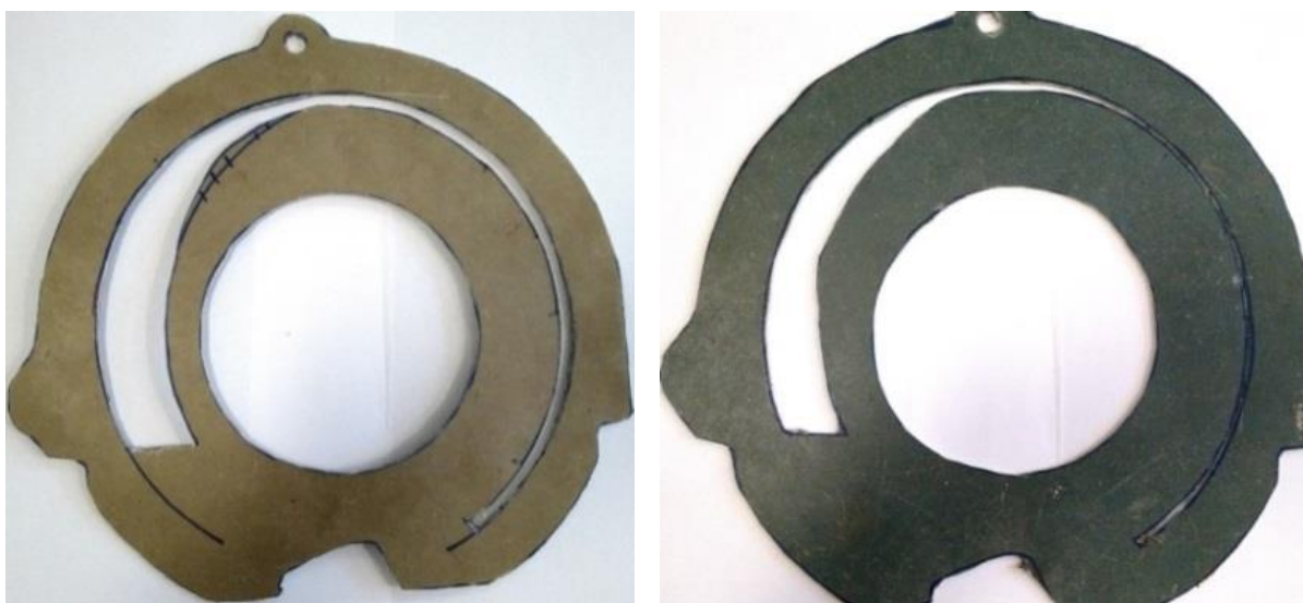
Рис. 2. Варіанти модернізованої прокладки вакуумної камери
