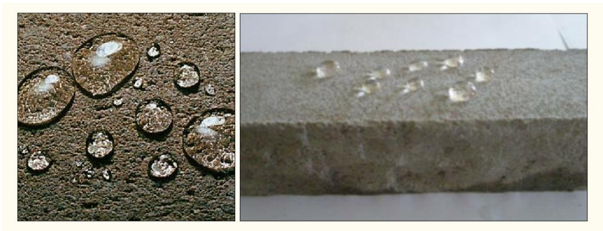
Рисунок 1 – Приклади вологовідталкування поверхнями гідрофобезованого бетону
