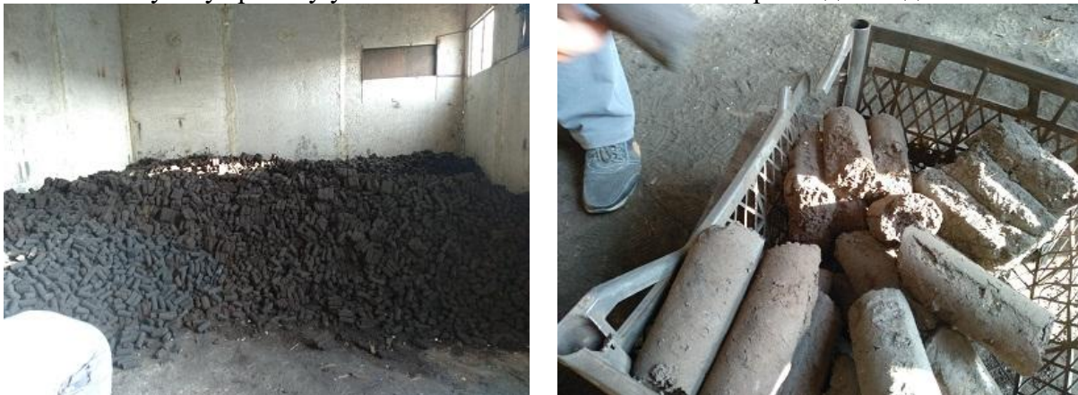
Рисунок 7 – Паливні брикети отримані в результаті утилізації зношених автомобільних шин
