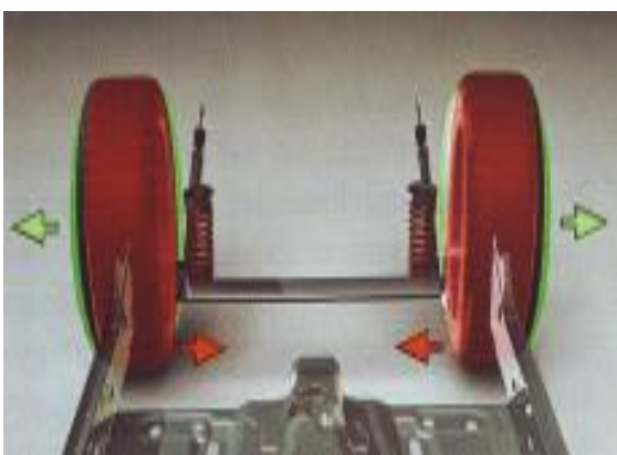
Рисунок 3 – Зміна кутів сходження задніх коліс за рахунок еластокінематики підвіски
