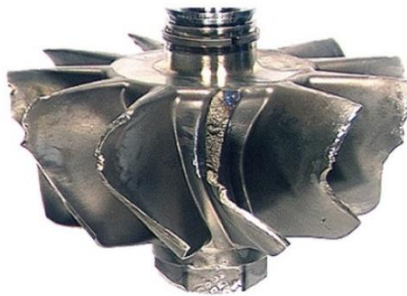
Рисунок 1 – Руйнування лопаток турбінних коліс
