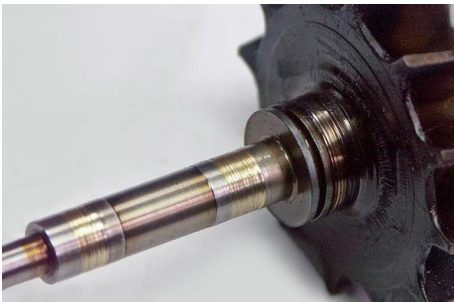
Рисунок 2 – Зношування вала ротора турбокомпресора
