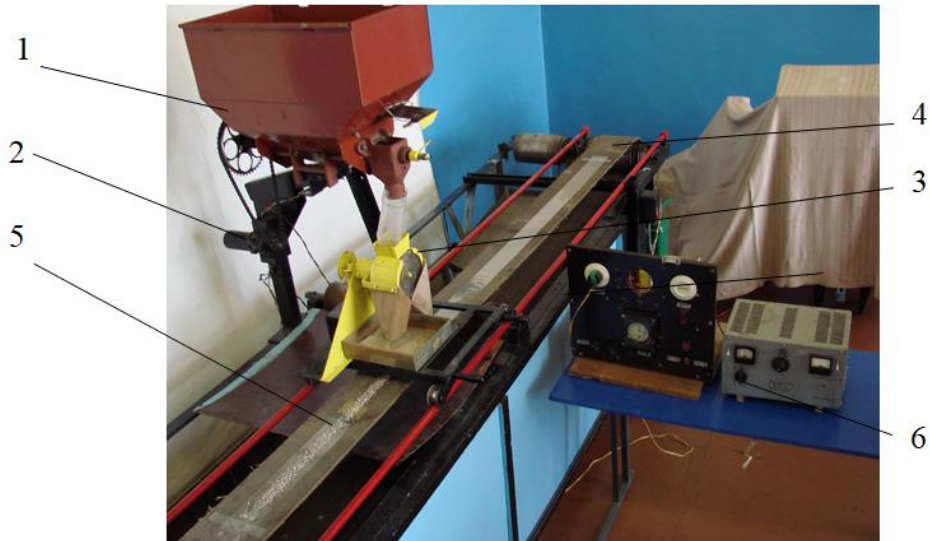
Рис. 1. Лабораторна установка: 1 - висівний апарат; 2 - електродвигун; 3 – пробовідбірник; 4 – стрічковий транспортер; 5 - скотч; 6 – пульт керування.
