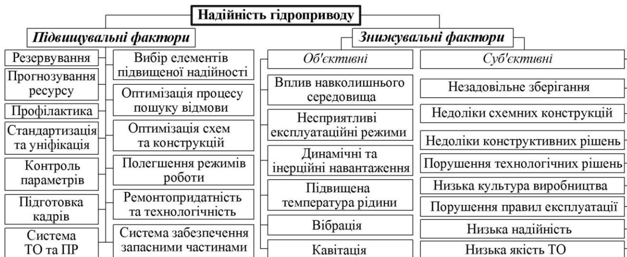
Рисунок 3 – Виробничі фактори, що впливають на надійність гідравлічних приводів сільськогосподарської техніки
