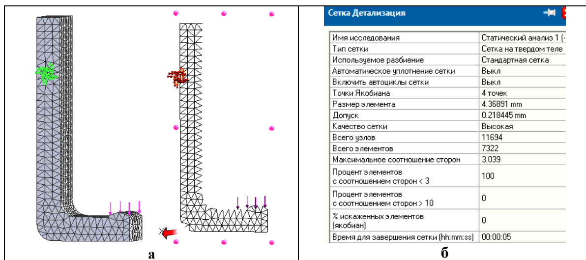
Рисунок 2 – Скінченно-елементна сітка вал-шестерні типу „на твердому тілі” (а) та її параметри (б)
