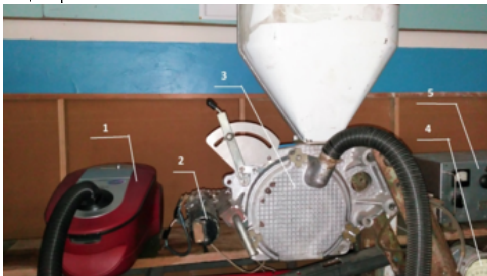
1 – пілосос «VCC4140V38», 2 – електромотор, 3 – висівний апарат сівалки УПС-8, 4 – манометр, 5 – випрямляч току ВСА-111К
