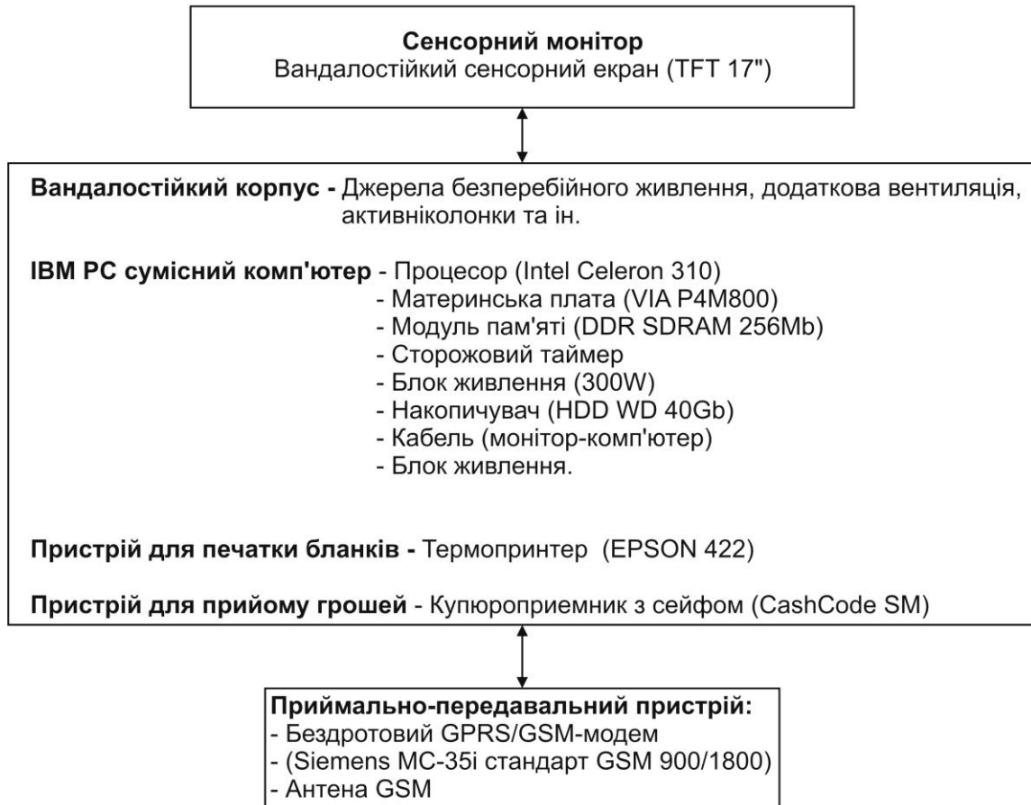
Рисунок 3 – Структурна схема апаратної частини
