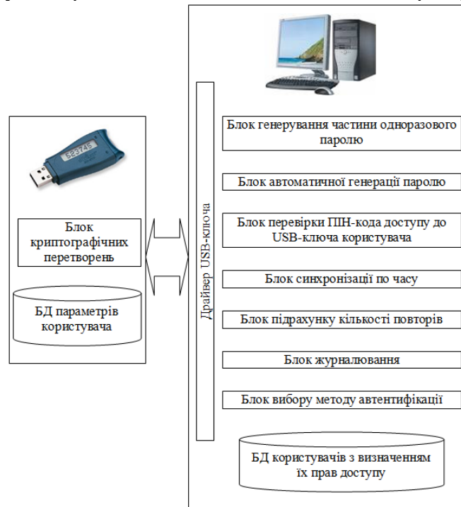
Рисунок 3 – Структурна схема системи автентифікації з використанням USB-ключа
