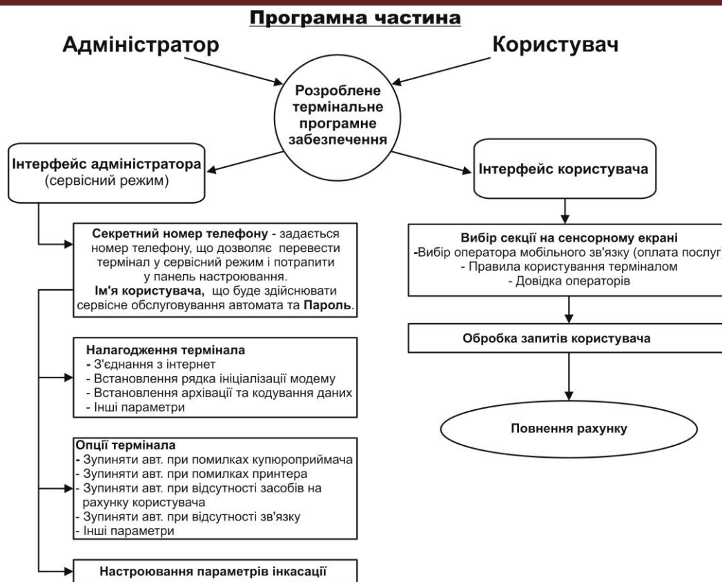
Рисунок 2 – Структурна схема програмної частини
