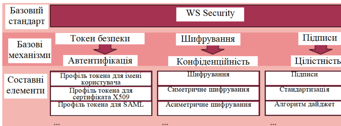
Рисунок 3 – Базові механізми WS Security
