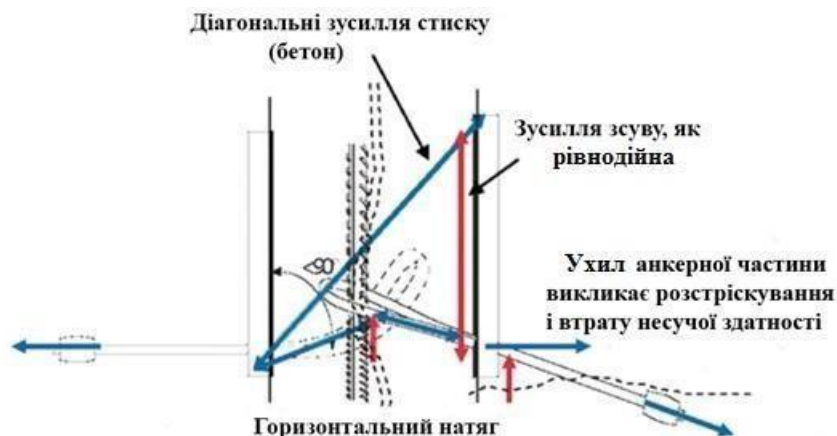
Рисунок 3 – Схема роботи петлі при встановленні з ухилом
