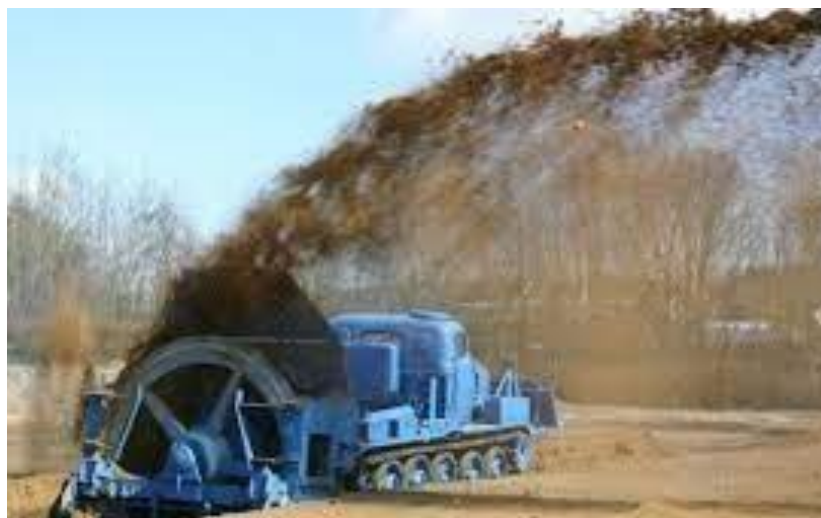
Рисунок. 1. - Застосування роторно-лопатєвого металника у землерійній машині МДК-2М
