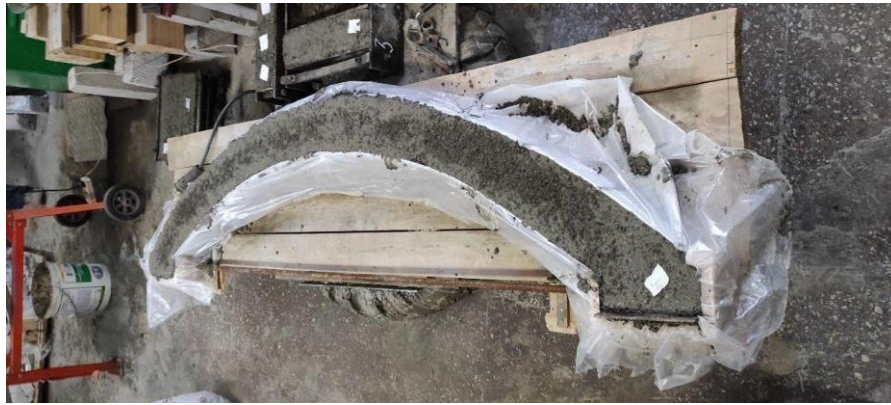
Рисунок 2. Дослідний зразок арки в процесі виготовлення
