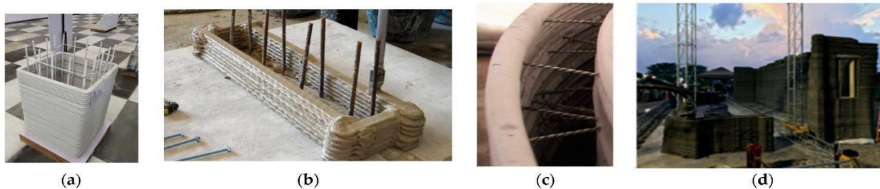
Рисунок 1 – Методи армування друківаного бетону, прийняті: а – WinSun; б – CyBe; с – CON; д - Печатні бетонні будівельні конструкції
