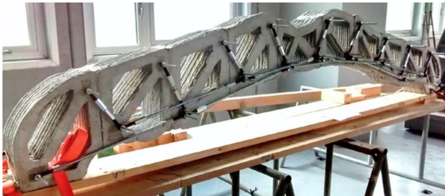
Рисунок 4 – Надруковані порожнисті залізобетонні блоки, зібрані та посилені зовнішньою сталеву арматурою
