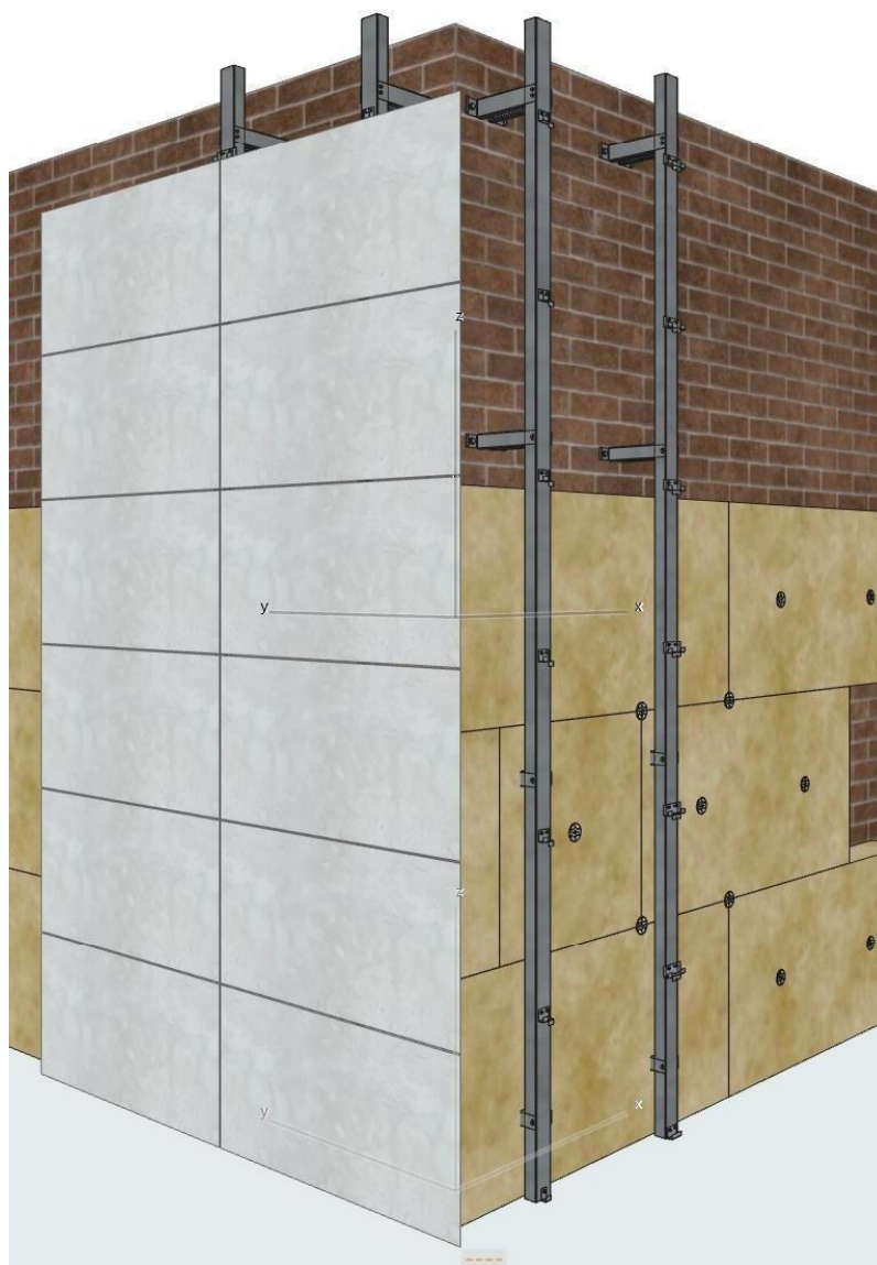
Рисунок 1 – Загальний вигляд системи вентиляваного фасаду
