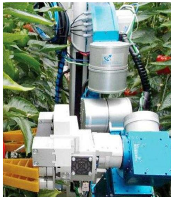
Рис. 2. Загальний вигляд агрообота для збирання перцю
